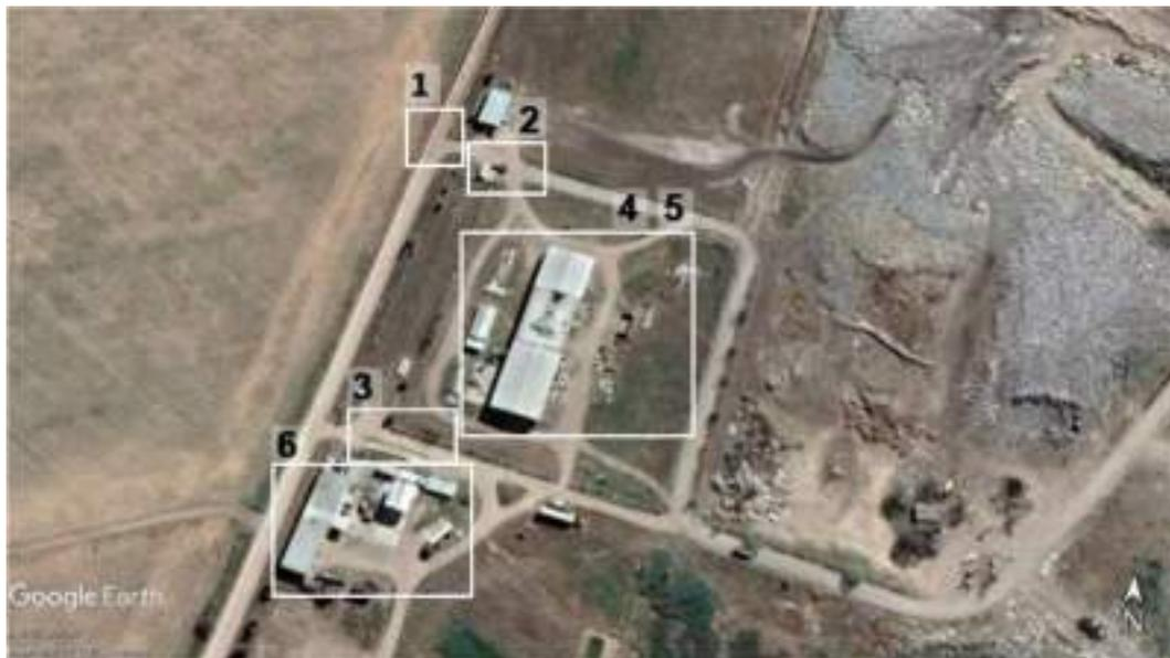
Portón de ingreso (1) Casilla de control (2), Balanza existente (3), Comedor (4), área de separación y acondicionamiento de material seco (5) y planta de tratamiento de residuos patogénicos (6).
