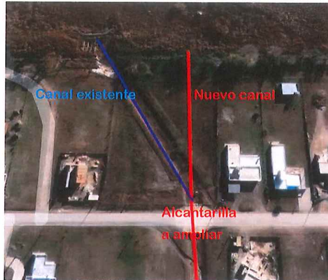
Cambio de traza canal interior, extremo Norte
