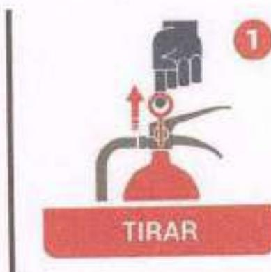
1. Tomar la boquilla de la manguera del extintor y comprobar, en caso que exista, que la válvula o disco de seguridad está en posición sin riesgo para el usuario. Sacar el pasador de seguridad tirando de su manija.
