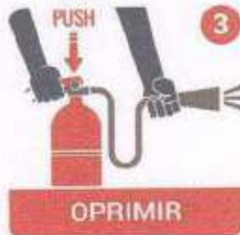
3. Dirigir el chorro a la base de las llamas con movimiento de barrido. En caso de incendio de líquidos proyectar superficialmente el agente extintor efectuando un barrido y evitando que la propia presión de impulsión provoque derrame del líquido incendiado. Avanzar gradualmente desde los extremos.
