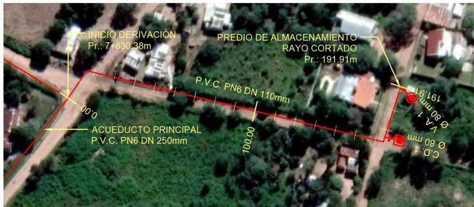
Figura N°23: Nuevo predio de almacenamiento en Rayo Cortado.
