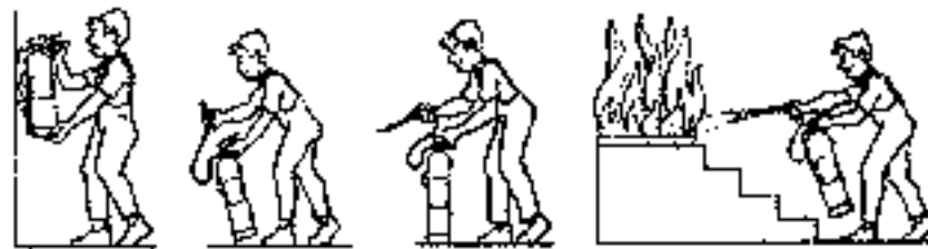
Figura 40: Accionamiento de extintor de incendio
