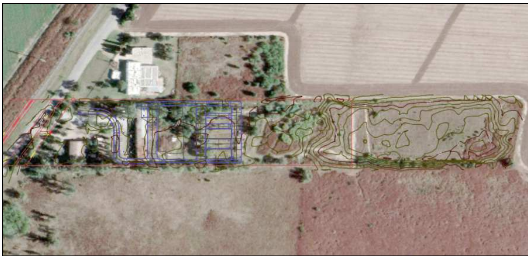
Fig.N°5: Curvas de nivel del terreno.
