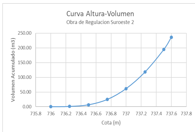
Figura N° 24.- Curva H-V Obra de Regulación SO2
