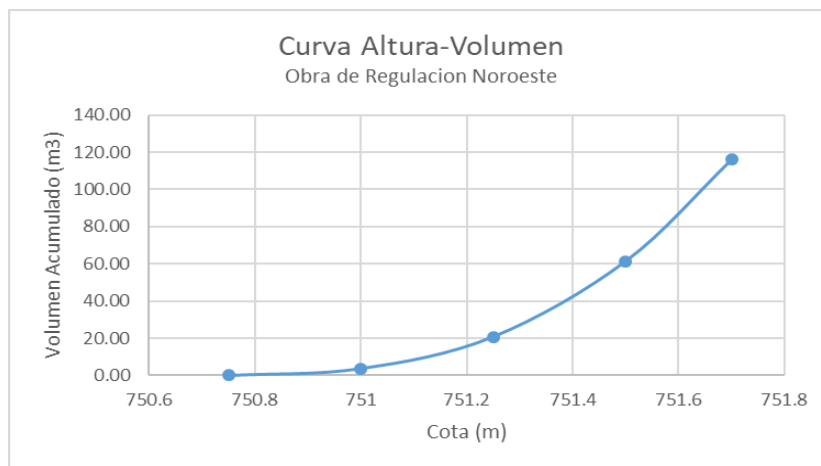
Figura Nº 18.- Curva H-V Obra de Regulación NO
