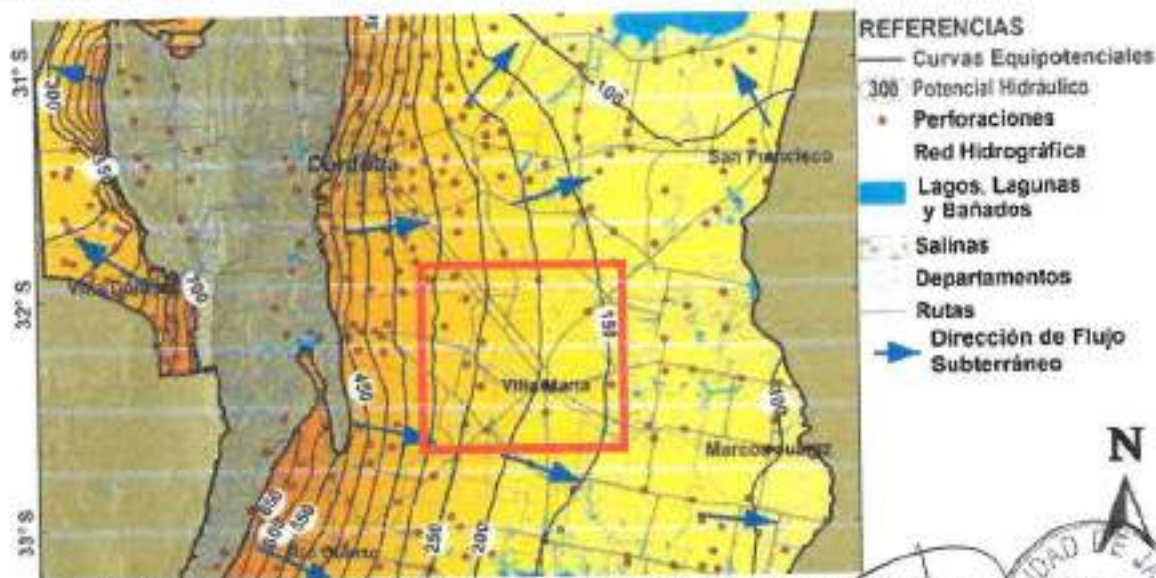
Imagen N° 4, Mapa de equipotenciales del acuífero libre de la Provincia de Córdoba, año 2013.
