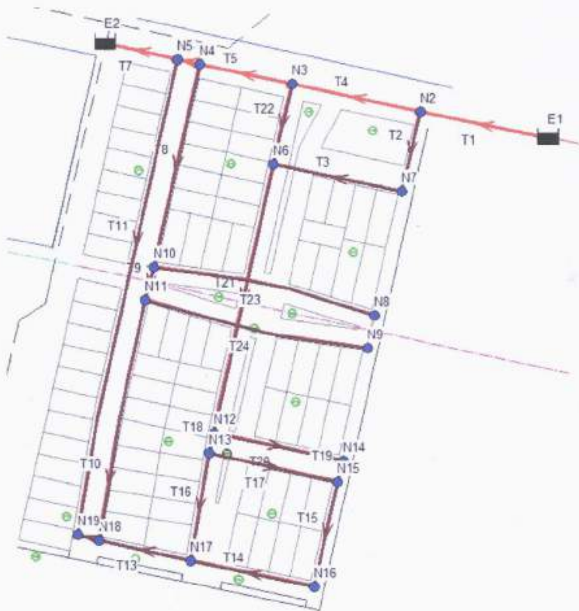
Fig. 1 - Esquema de nudos y tuberías de la red
