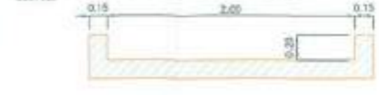
CORTE TRANSVERSAL OBRA DE INGRESO ESC. 1:20
