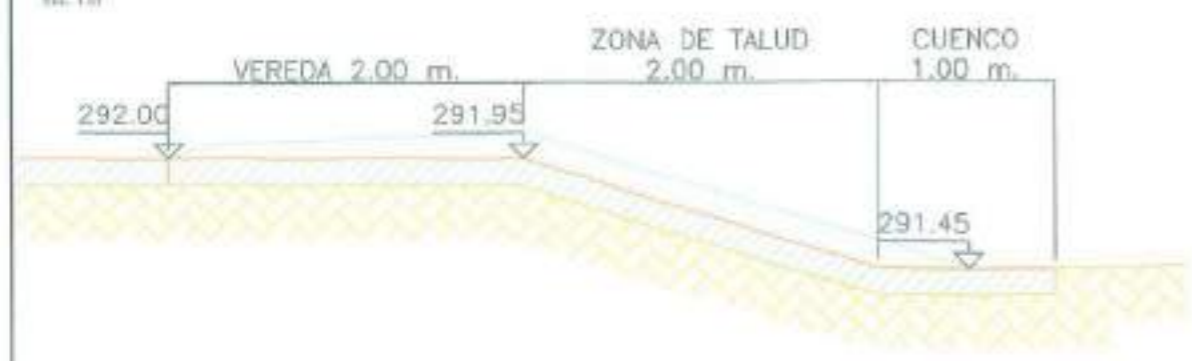
CORTE LONGITUDINAL OBRAS DE INGRESO ESC. 1:20
