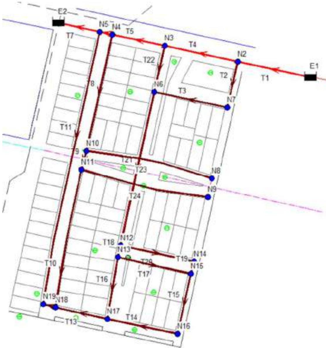
Fig. 1 - Esquema de nodos y tuberías de la red
