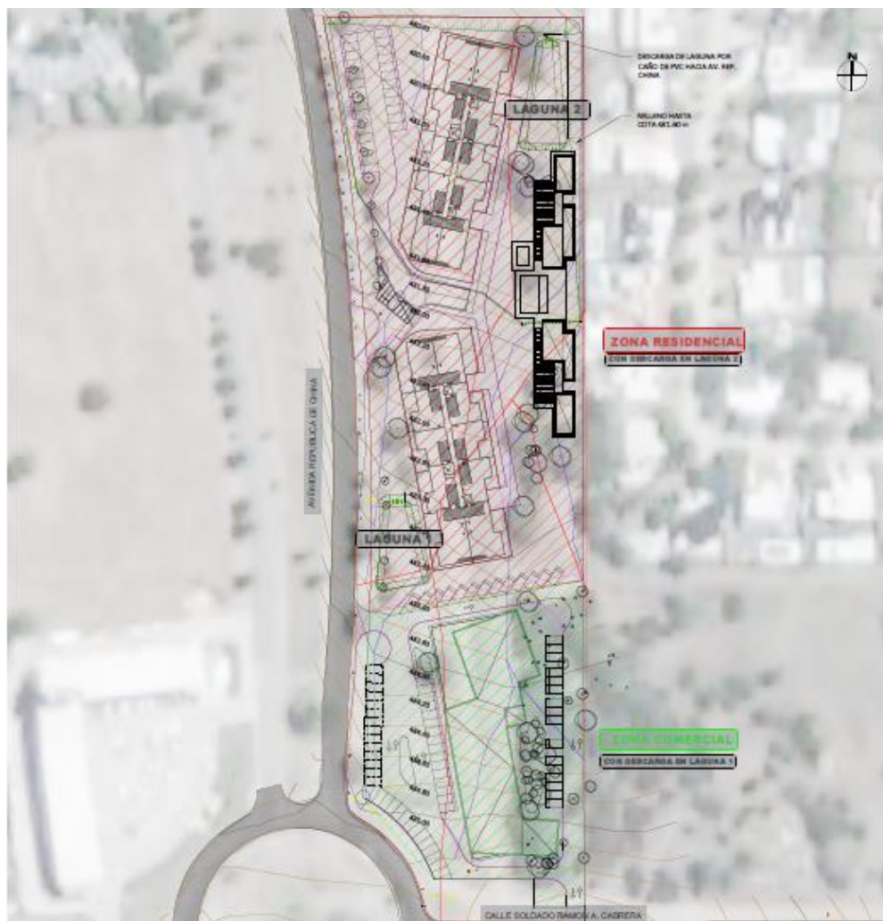
Ilustración 19 Planimetría General - Sistema de Drenaje proyectado
