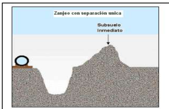
Imagen 8: Excavación y separación de suelos.
