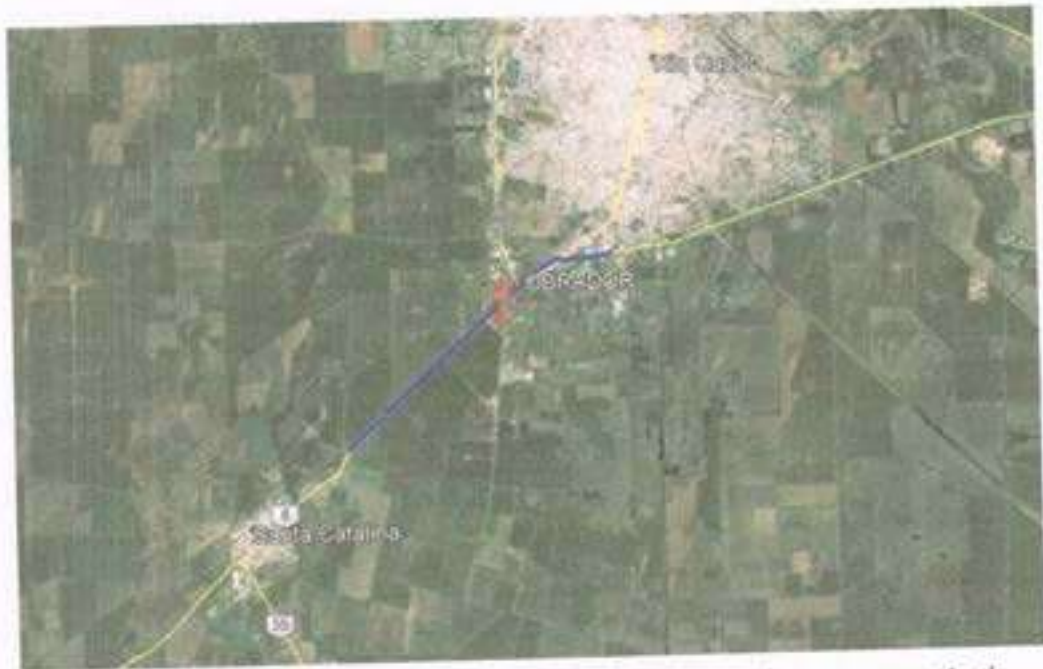
Figura 3: Ubicación del obrador, planta asfáltica y planta hormigonera respecto de la localidad de Río Cuarto y Santa Catalina. En azul, la zona de obra a la cual da soporte.
