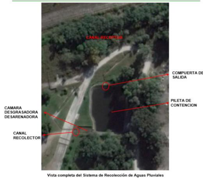
Figura 9. Ubicación de piletas pluviales
