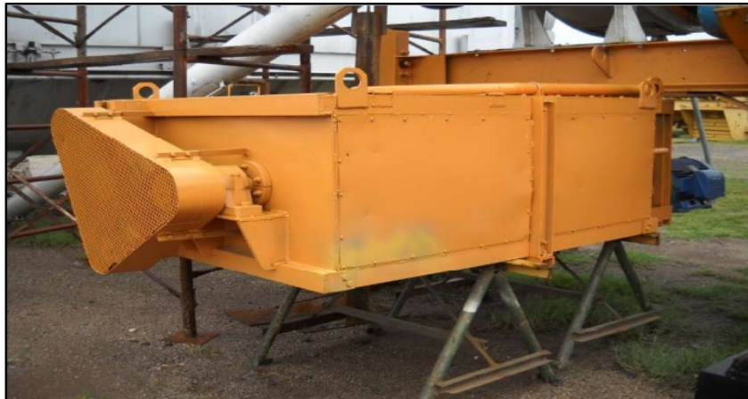
Figura 7. Mezclador externo de materiales de planta asfáltica "Ciber" modelo "Super UADM-100".
