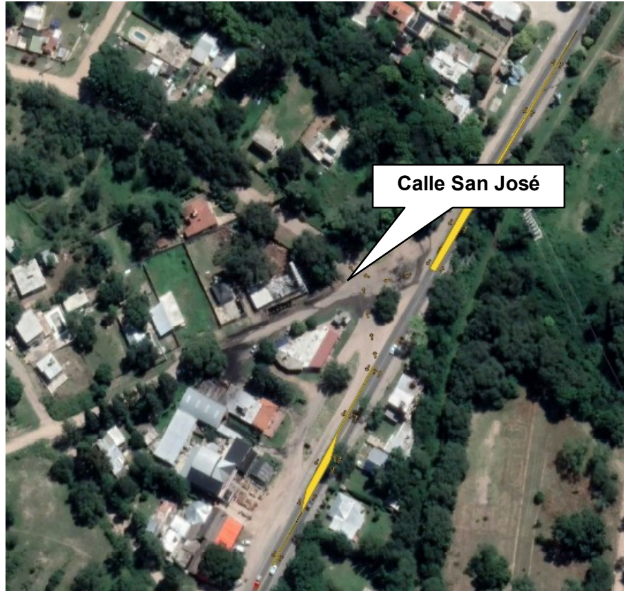
Figura 26. Dársena de giro proyectada para permitir el ingreso de vehículos livianos y pesados al obrador por calle San José.
