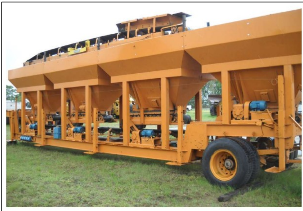
Figura 5. Silos pre-dosificadores de planta asfáltica "Ciber" modelo "Super UADM-100".
