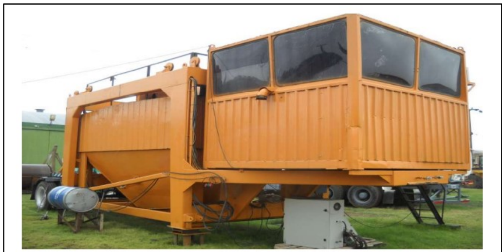
Figura 4. Cabina de operación de planta asfáltica "Ciber" modelo "Super UADM-100".
