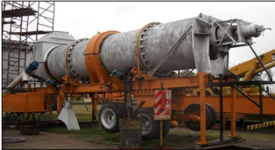
Figura 6. Tambor secador de planta asfáltica "Ciber" modelo "Super UADM-100".
