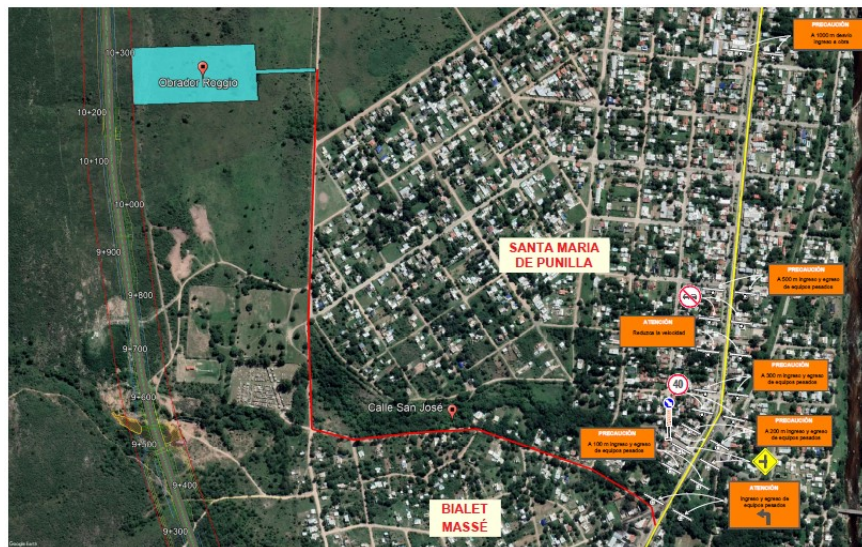
Figura 27. Disposición de cartelería vertical sobre RN N° 38.
