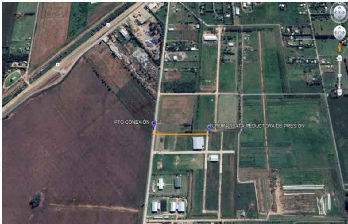
Imagen 2: Ramal de Alimentación 25 Kg/cm 2
