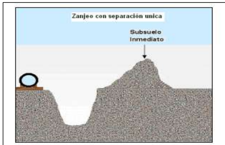
Imagen 7: Excavación y separación de suelos.
