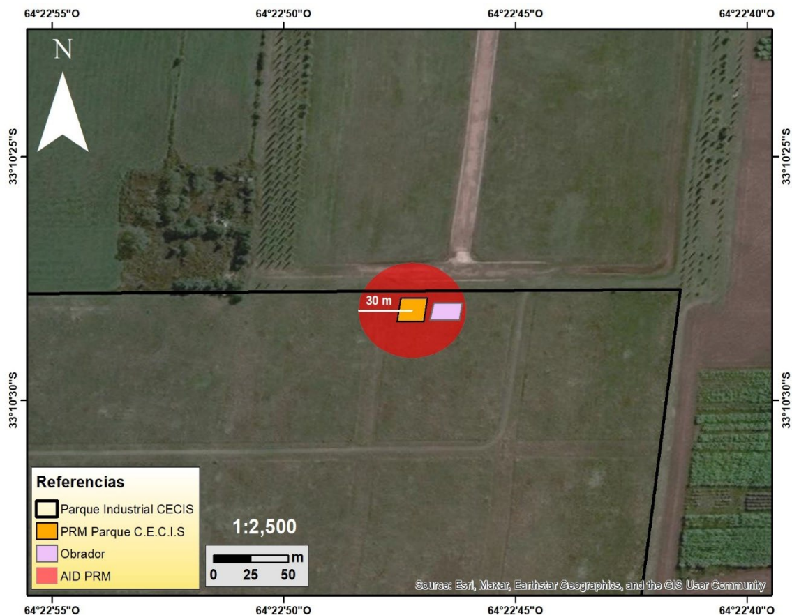
Figura 3. Área Influencia Directa del Proyecto según NAG 153. El rectángulo de color rojo, corresponde al AID de la PRM. Fuente: Elaboración propia.
