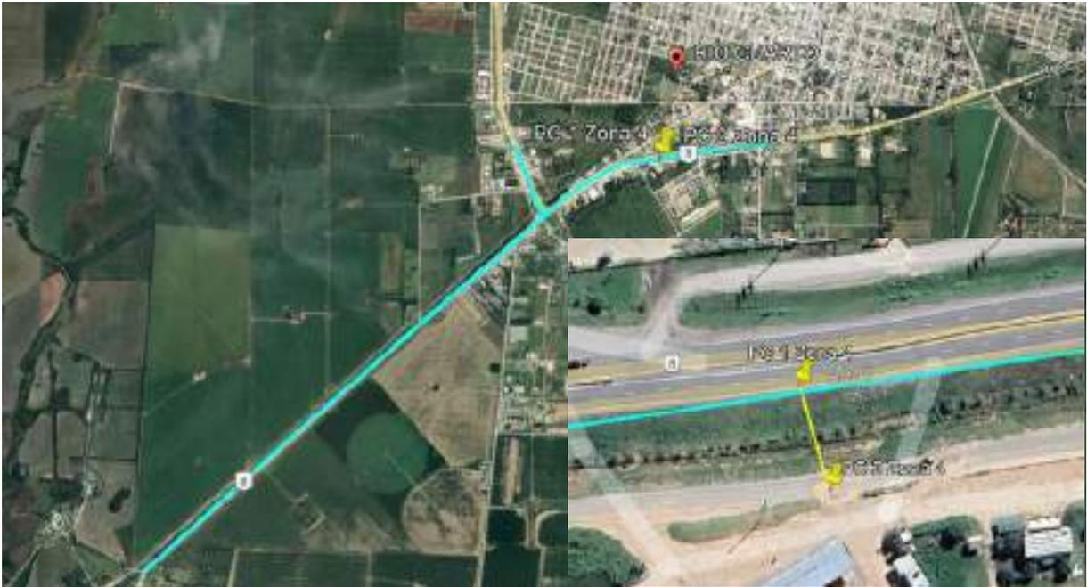
Figura 3: Ubicación del ramal a relocalizar (Zona N° 4, en amarillo), respecto de la obra vial de "Duplicación de calzada" (en celeste).
