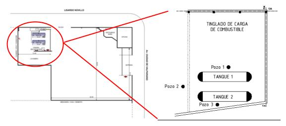
El sector de carga de combustible tiene una superficie aproximada de 70m² con canaletas y rejillas metálicas colectoras que desembocan en cámara estanca.
