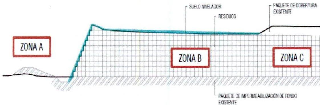
Imagen 5- Detalle de suelo nivelador
