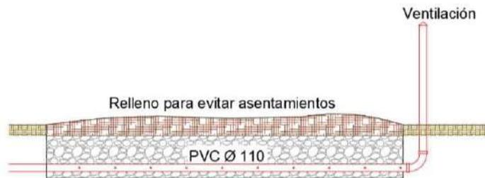
Figura 2: Esquema de zanja de absorción / Perfil Longitudinal
