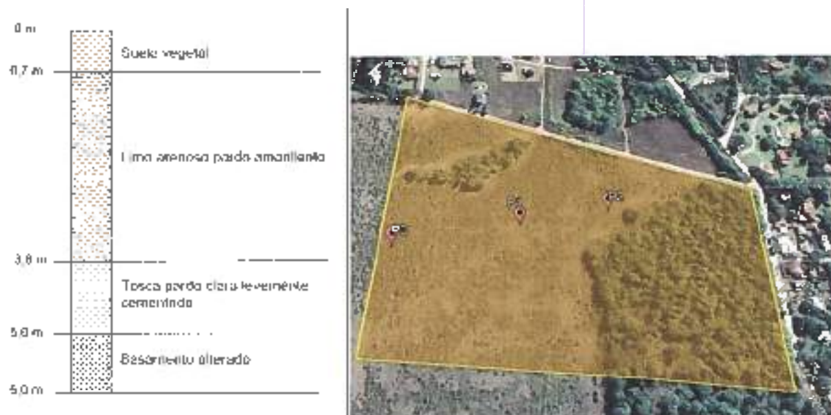
Figura 7. Perfil geológico del terreno del predio.
