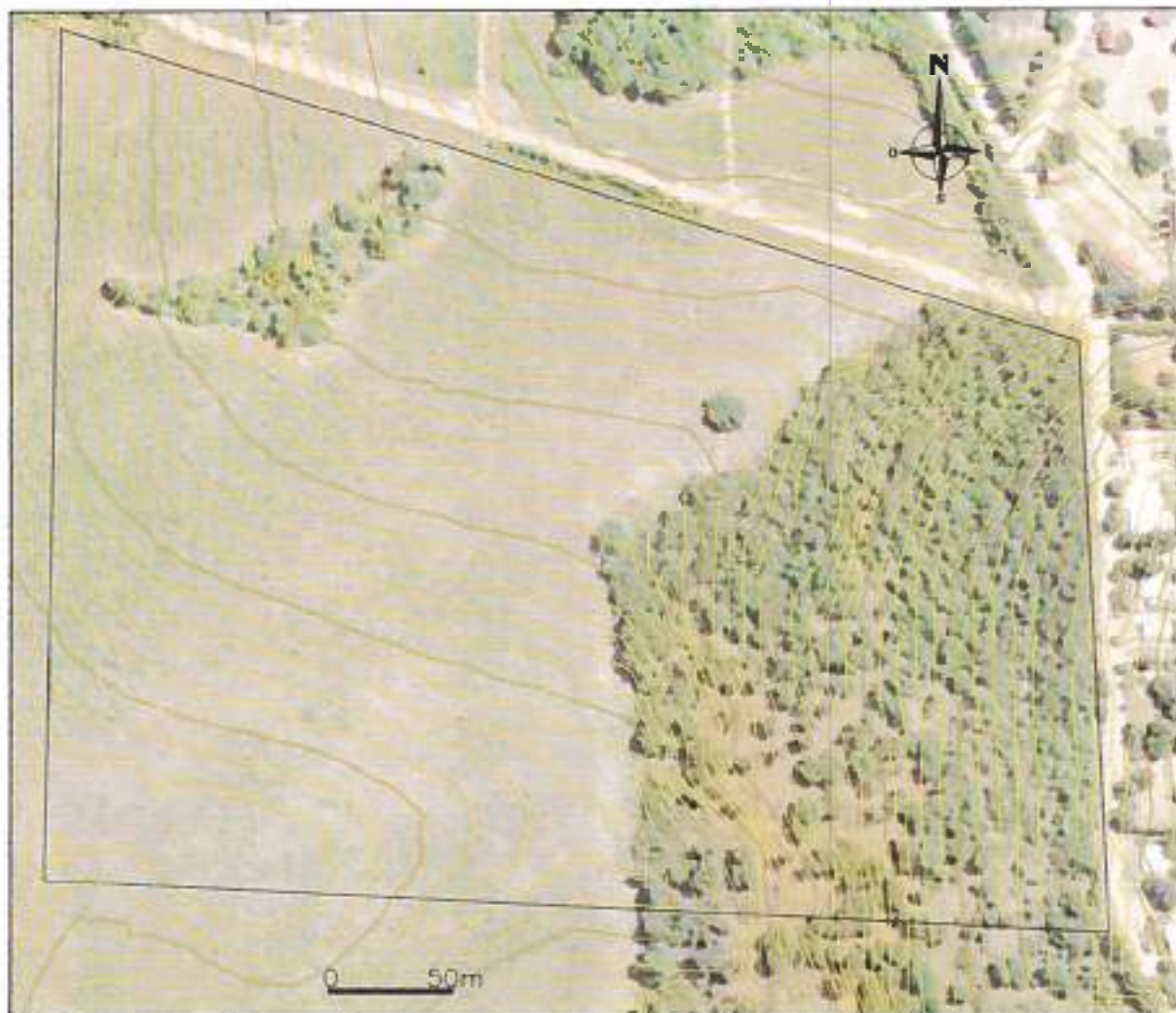
Figura 2. Vista satelital de uso de suelo actual. Curvas de nivel equidistancia 0,50 m
