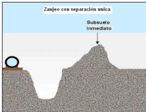
Imagen 9: Excavación y separación de suelos.
