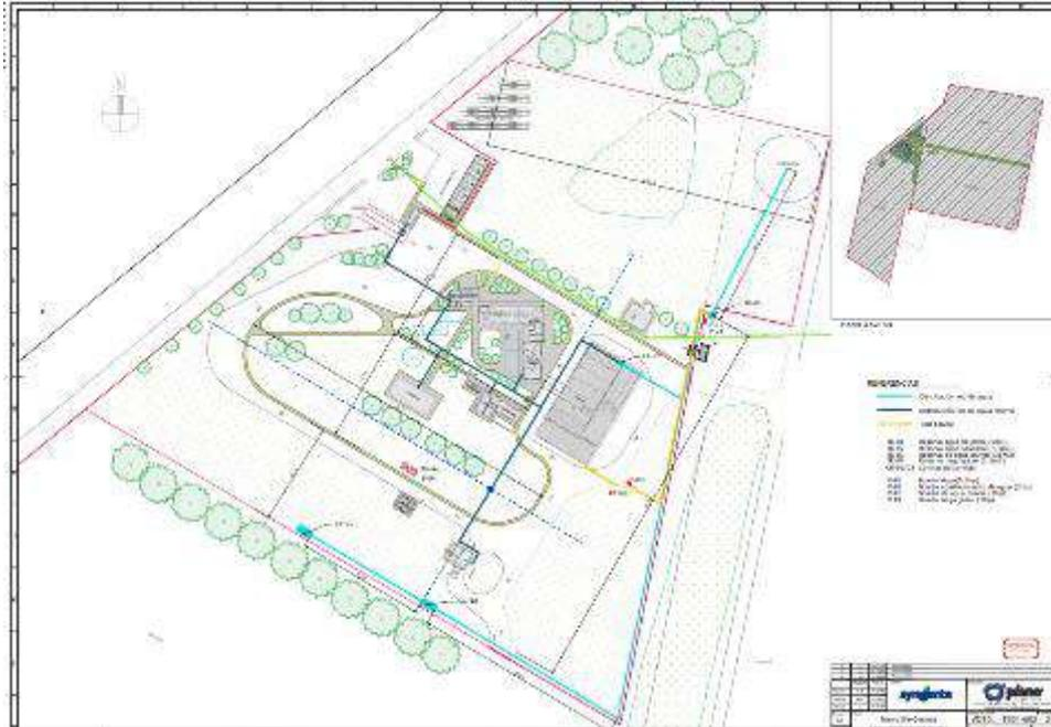
**Imagen 6:** Plano de recolección y almacenamiento de aguas grises y pluviales destinadas a riego.
