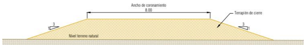
Figura N°6: Alteo de protección en caminos
