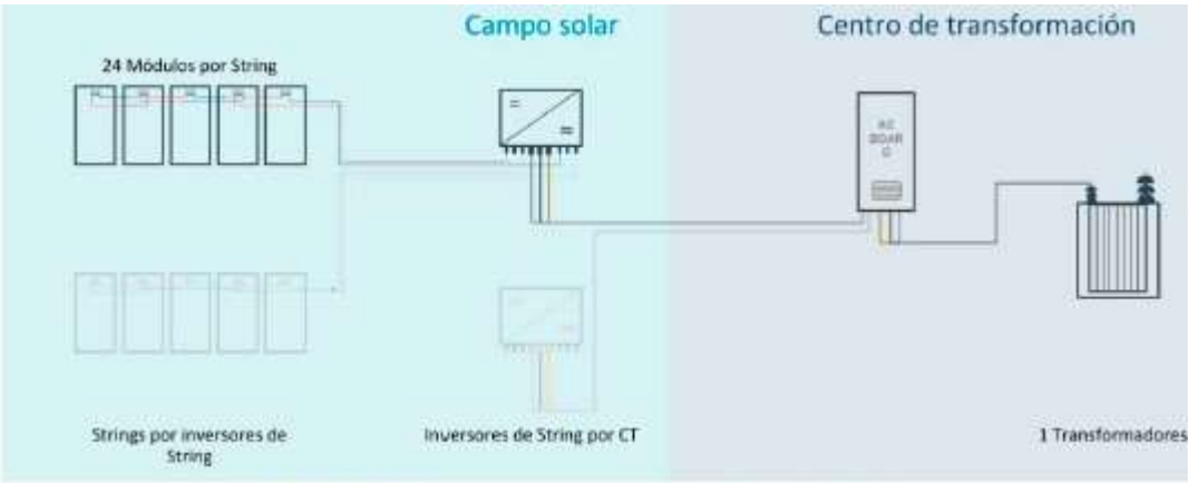
Fig 2: Configuración de la Planta Solar
