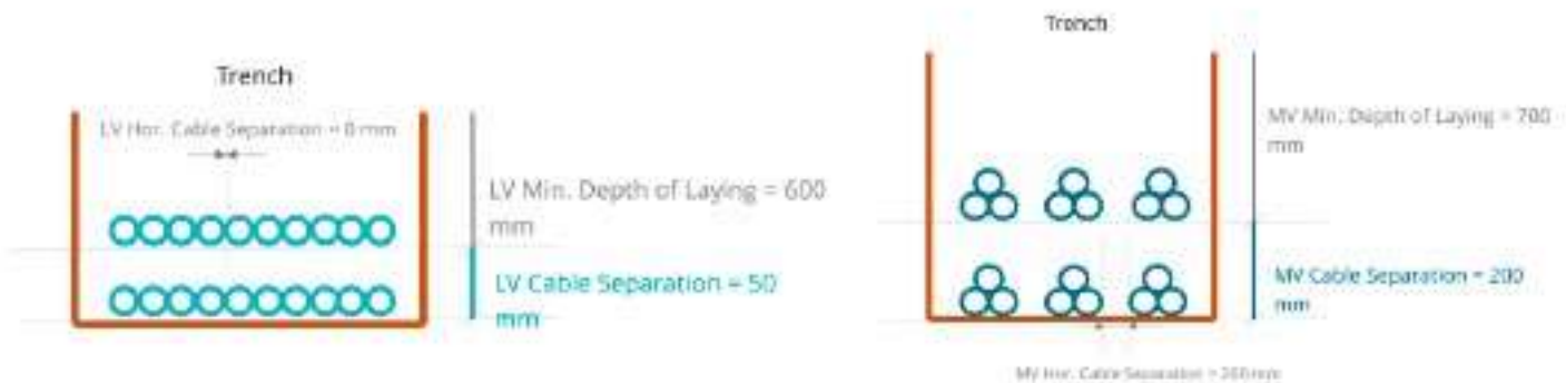
Fig 4: Disposición de cables en las zanjas
