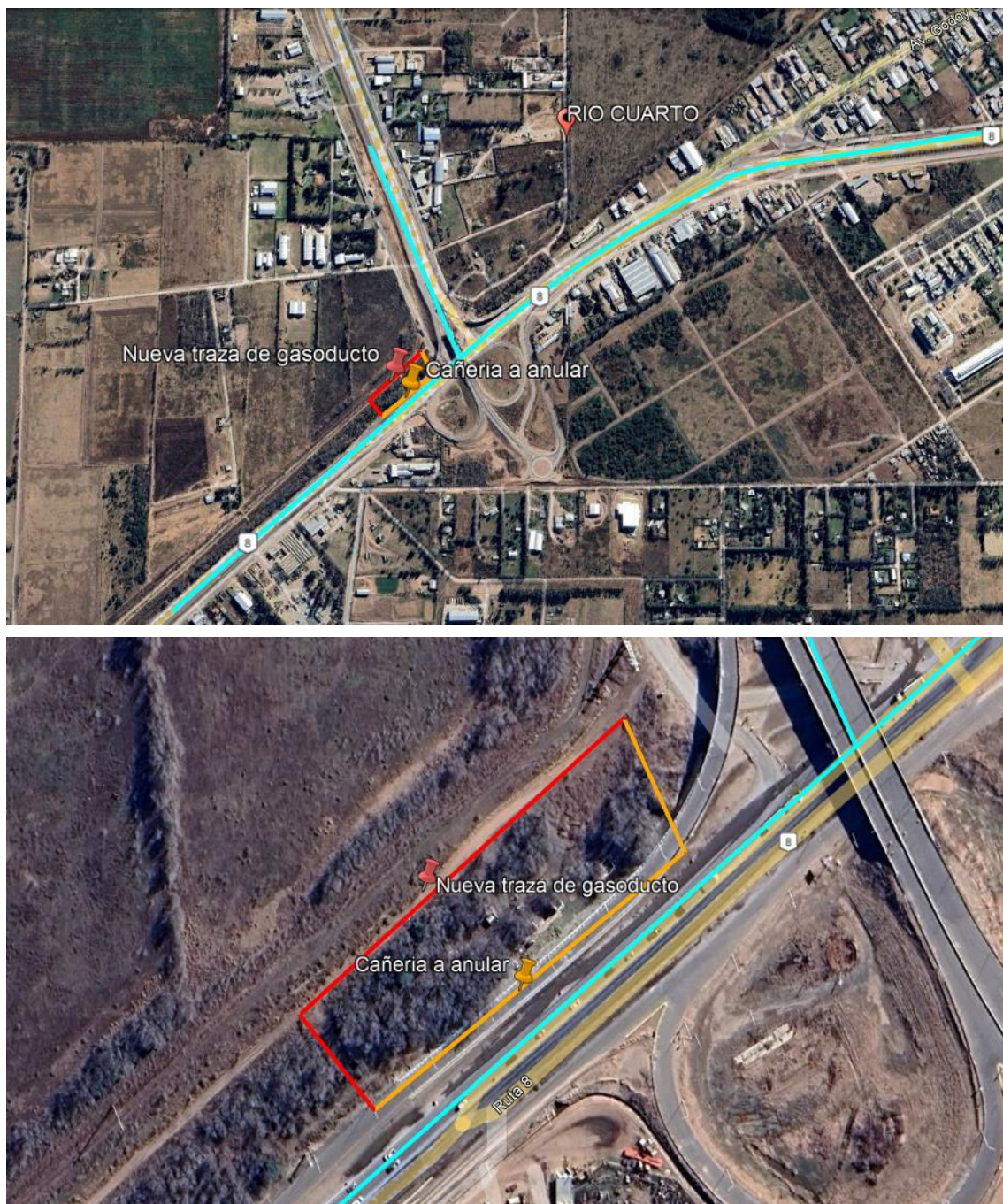
Figura 1: Ubicación del ramal a relocar (Zona N° 7, en rojo), respecto de la obra vial de “Duplicación de calzada” (en celeste). En naranja, la traza de la cañería a anular.
