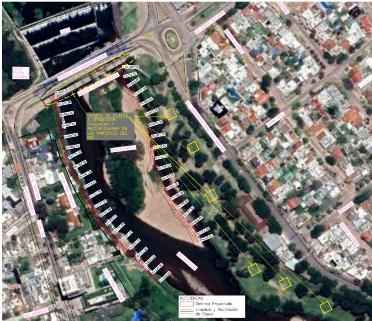
Figura 19: Desmontaje, traslado y reconfiguración de tramos del Puente Vélez Sársfield.
