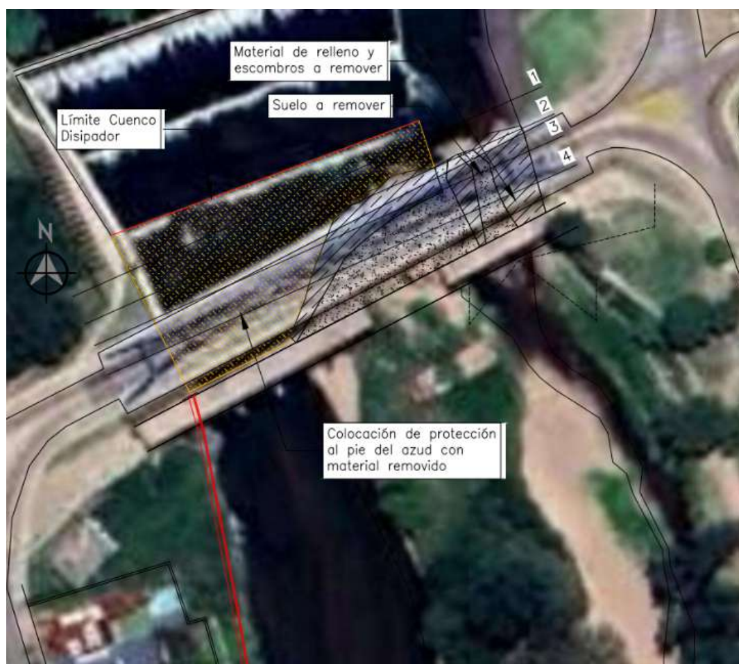
Figura 14: Remoción de material de obra previa.
