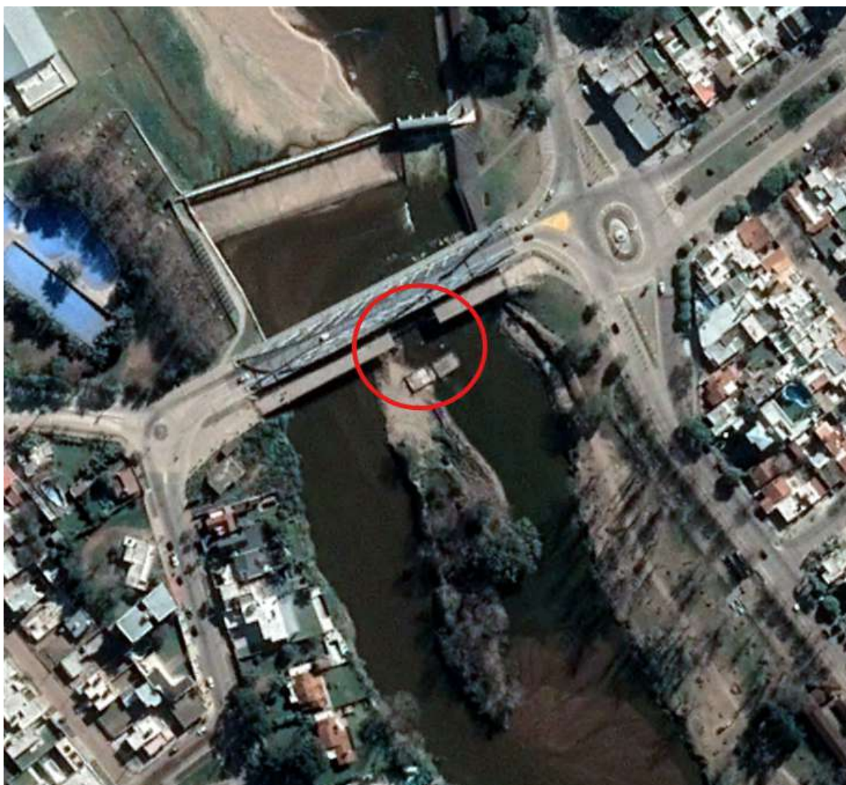
Figura 8: Imágen satelital del ex puente Vélez Sársfield y su tramo derrumbado sobre el Río Ctalamochita, año 2019.
