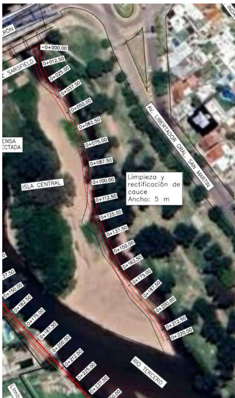
Figura 12: Planimetría de rectificación de cauce.
