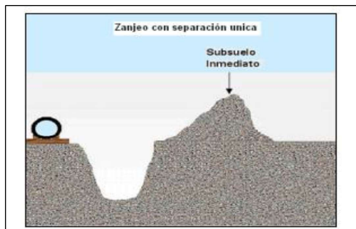
Imagen 6: Excavación y separación de suelos.
