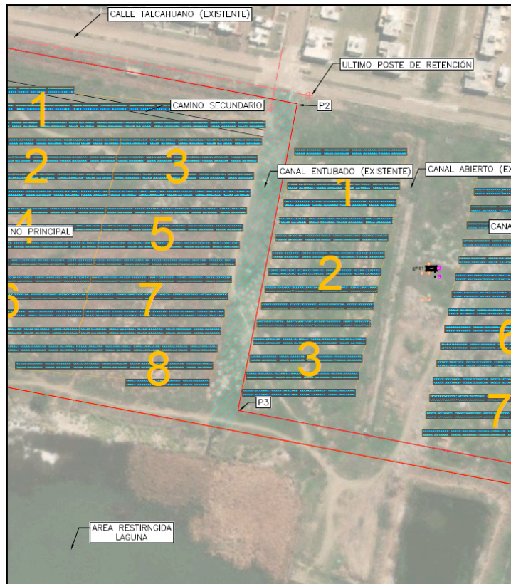
Imagen 7. Ubicación de los canales existentes que se preservarán, uno entubado y otro abierto. Ambos desembocan en las lagunas de retención. Recorte del Plano Layout General.
